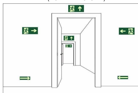
Figura 5: Exemplo de instalação de Placas de Sinalização acima da porta e na parede
