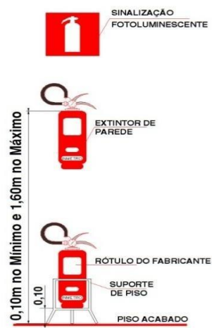
Figura 3: Detalhe de fixação e sinalização do extintor
